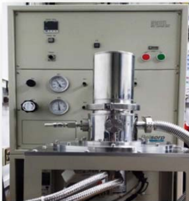
Adsorción-desorción de Hidrógeno. Isothermas a 77 K, de 0 hasta 60 bar.
