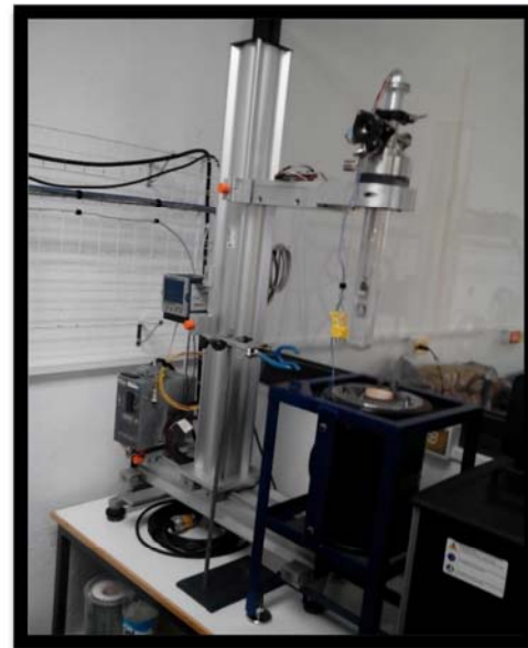
Instalación para medir coeficiente de Seebeck
